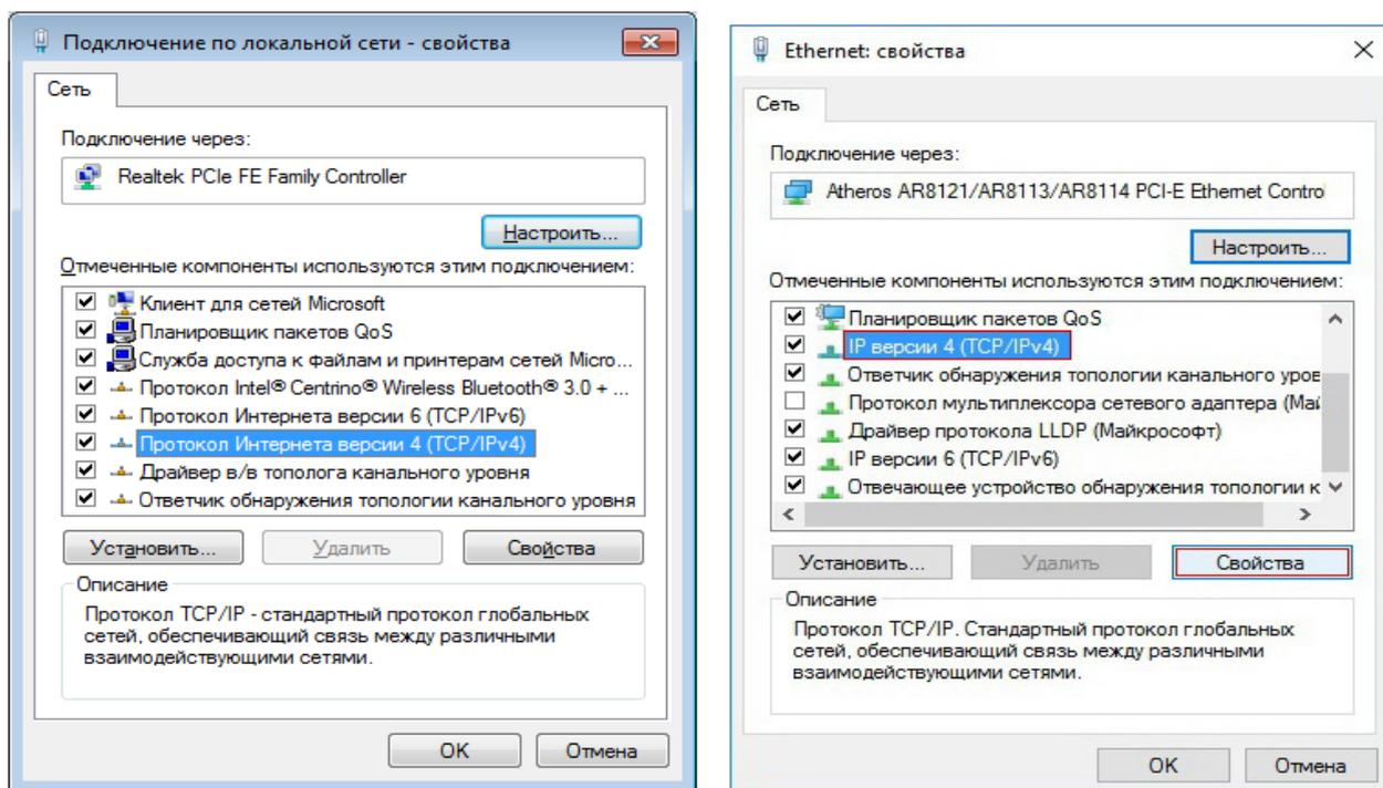
Рис. 4. Свойства сетевого подключения на ОС Windows Vista/7 и выше.
