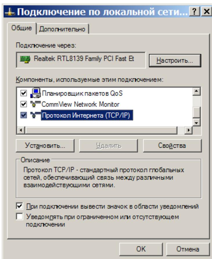
Рис. 3. Свойства сетевого подключения на ОС Windows 2000/XP.
