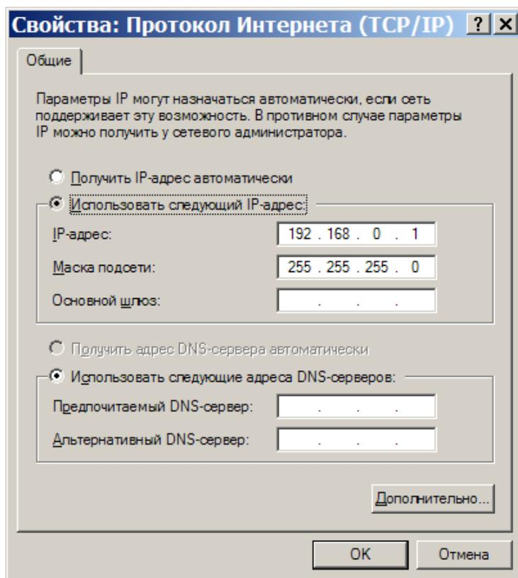
Рис. 5. Свойства протокола TCP/IP на ОС Windows 2000/XP.
